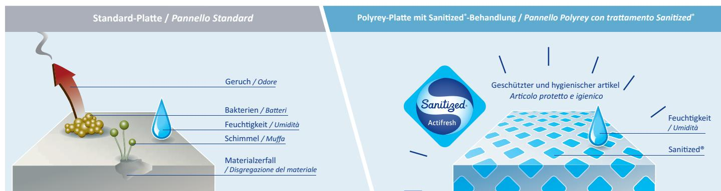
Dieses Biozid-Additiv wird in das Material integriert, um antibakteriellen Schutz für seine gesamte Lebensdauer zu gewährleisten und beeinträchtigt weder die technischen Leistungswerte noch die Ästhetik unserer Platten.
